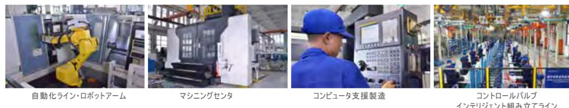
自動化ライン・ロボットアーム      マシニングセンタ      コンピュータ支援製造      コントロールバルブ
